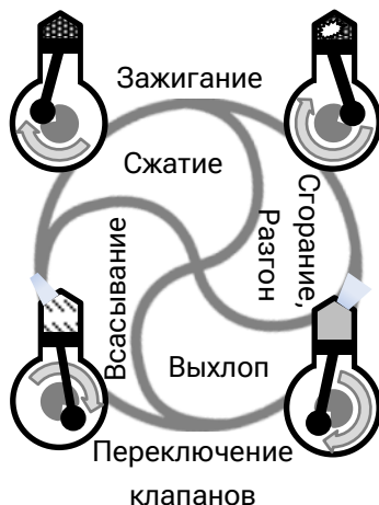
Рис. 1. Цикл работы ДВС
